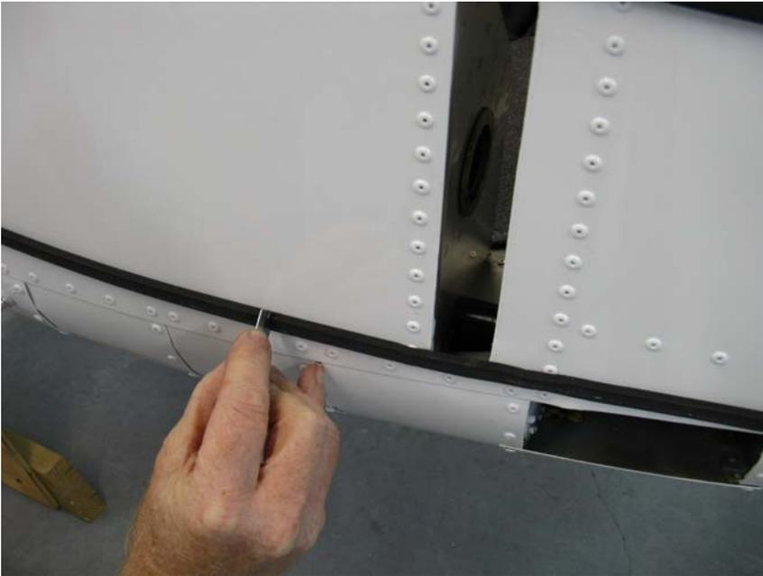
**FIGURE 3:** CUTTING SEAL STRIP
